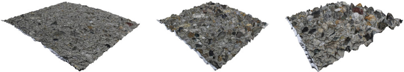
Abb. 2: Digitales Oberflächenmodell der verschiedenen Rauigkeitskategorien (glatt \leq 1,5 mm, rau \leq 3,0 mm, verzahnt \geq 3,0 mm).
