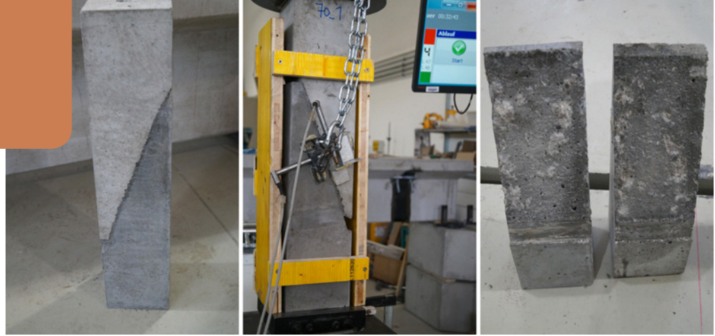
Abb. 6: Versuchskörper, Versuchsaufbau und Bruchfläche Slant-Shear-Test.
