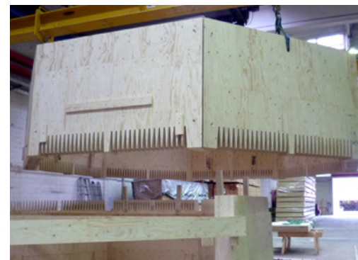
5.1.5: Es muss nicht immer Stahl sein: Züblin setzt bei dieser 140 m hohen Windenergieanlage ganz auf den Werkstoff Holz (links und unten).
