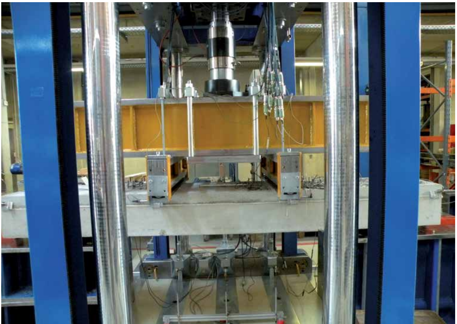
2.4: Schubversuch einer dünnen UHPC-Schicht auf Stahlbetonteil
