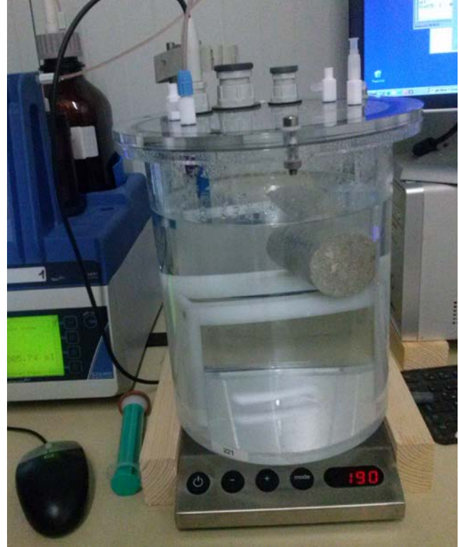
Abbildung 3: Beispiele für Dauerhaftigkeitsprüfung von Spritzbeton (oben: Lösungsverhalten bei \text{pH}_{\text{Stat}} -Bedingungen; Mitte: Prüfung von Sulfatangriff).
